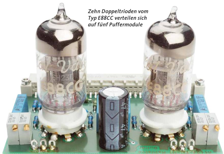
*Zehn Doppeltrioden vom Typ E88CC verteilen sich auf fünf Puffermodule*
